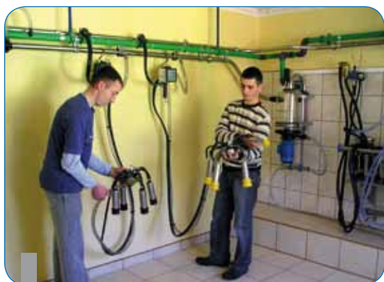
Nauka obsługi nowoczesnych dojazdów
